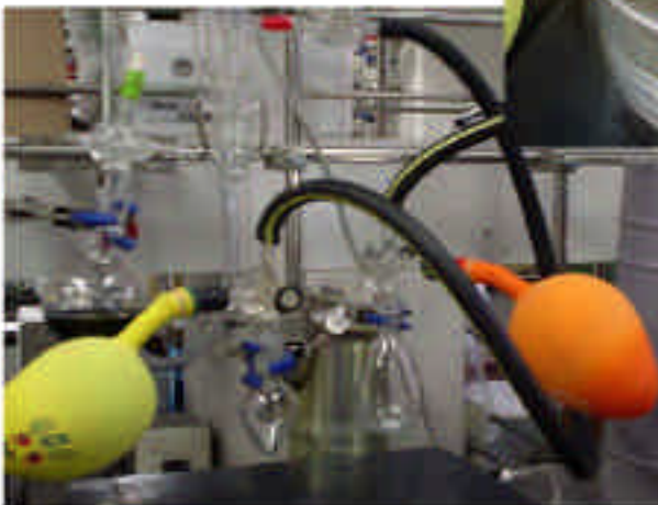
凍結脱気（ frozen-thow methode ）
